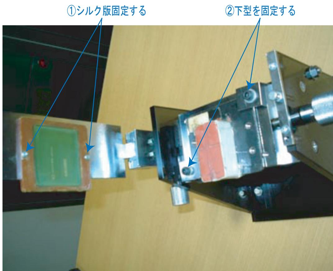
③インクを作る ④被印刷物を下型上に置く ⑤シルク版を印刷物の上を下ろす
